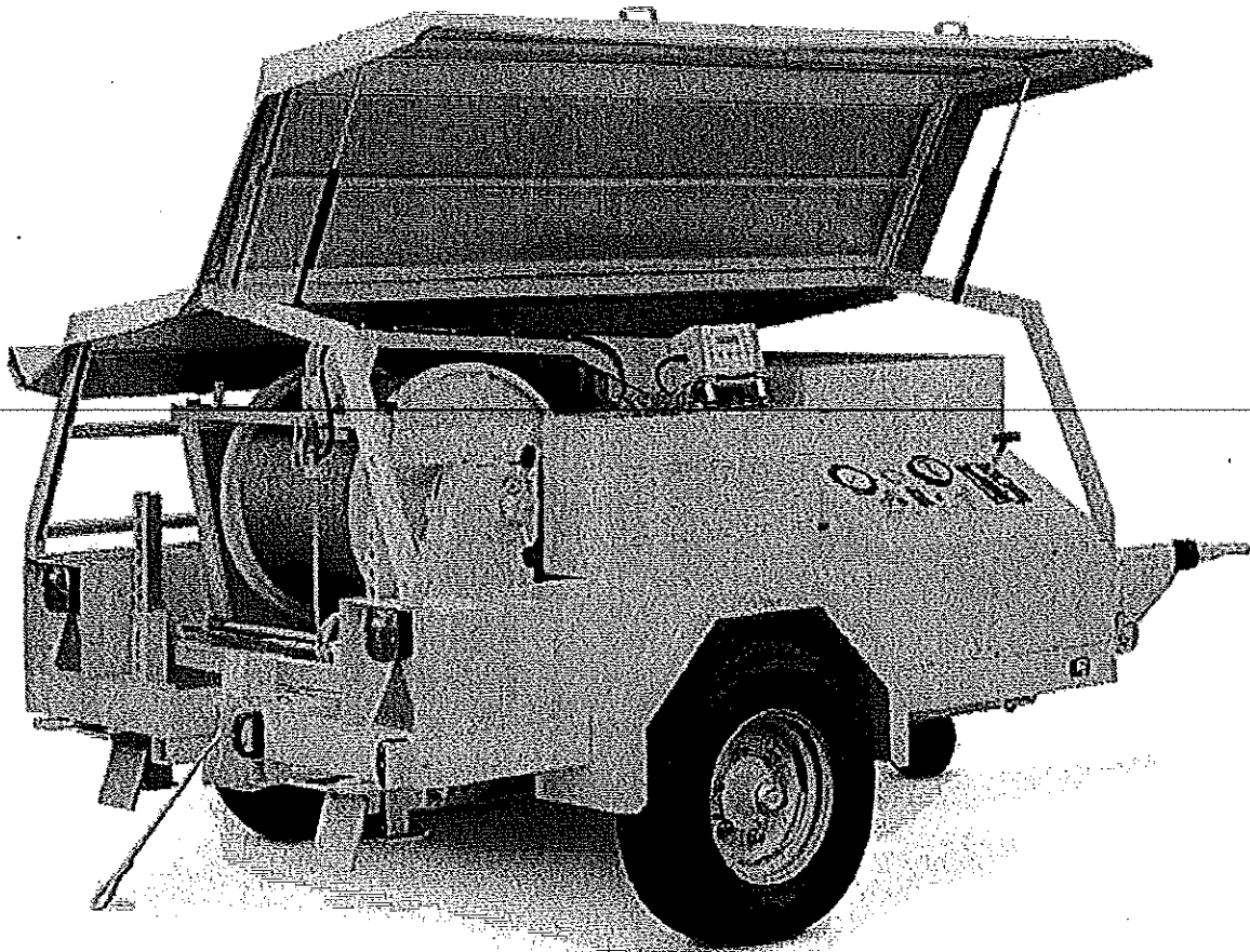
Рис.К1. Лебедки с дизельным двигателем с тяговым усилием 40-50 кН в комплекте с электронным регистратором MPZ 30/55 и динамометром ZK 40/50
